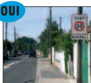
1• Le cas le plus simple, avec juste un panneau de limitation de vitesse à l'entrée et des passages piétons protégés assez fréquents : adapté seulement dans les rues à trafic faible et où le passage à 30 km/h est assez naturel.
